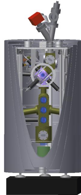
**Abbildung 6.1: Schematische Darstellung des QG-1.** Im oberen Bereich in der Magnetfeldabschirmung befinden sich die 2D- und 3D-MOT mit dem Atomchip. Vibrationen werden durch eine Isolationsplattform unterdrückt, verbleibende Vibrationen können mit dem Seismometer am Boden der Magnetfeldabschirmung aufgenommen werden.
